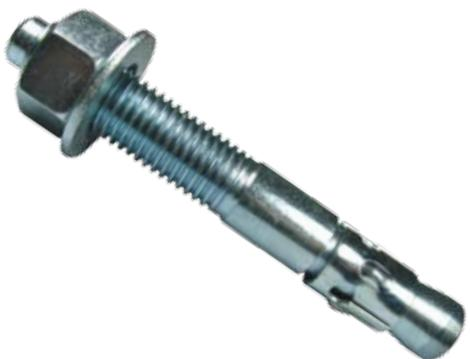
➤ De rosca exterior de acero al carbono galvanizado mediante electrozincado. La expansión se efectúa por la cuña que se fuerza contra la sección cónica extrema a medida que se aprieta la tuerca.
