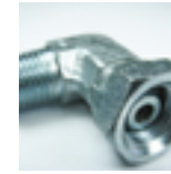
Adaptador codo 90° hembra NPSM-macho NPT
