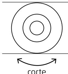
Para secciones de corte grandes, hacer pendular la máquina hacia adelante y hacia atrás.
